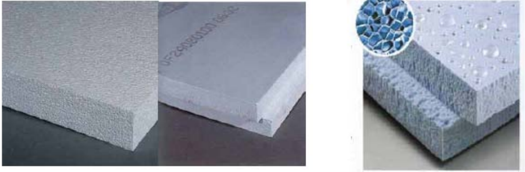
Слика 8 Органски топлинско изолациони материјали – вештачки – тврди плочи – експандиран полистирен и екструдирани полистирен, структура на затворени ќелии - минимално впивање на вода
